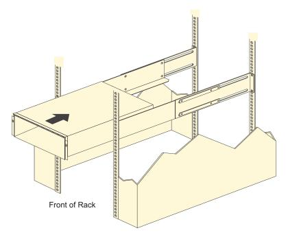
Figure 19. Installing the DS5020
